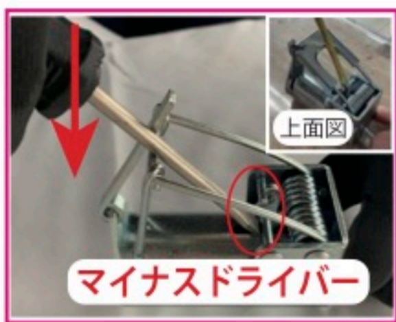
① マイナスドライバーを○部分に差し込み下に押し下げる。
