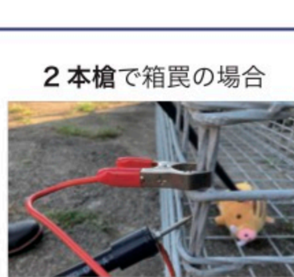
槍先をメッシュに接面させる。又は付属クリップを装着しアースをとる
