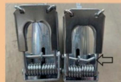
バーが破損し セッティング不可となったアラホール(右)
