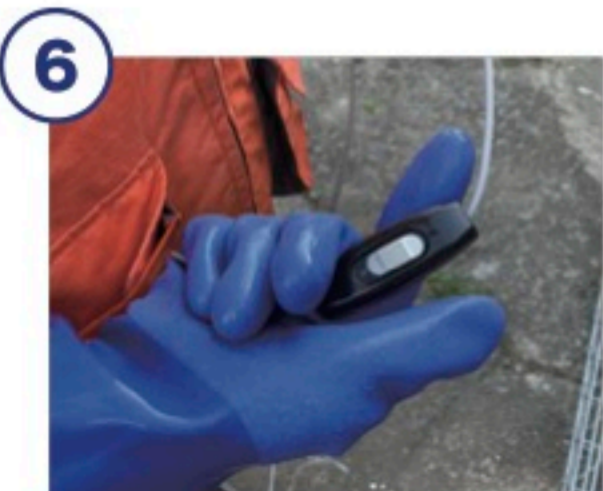
⑥ 電気止め刺し機手元スイッチを入れる
