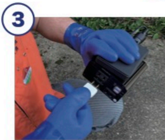
③ インバーターと電気止め刺し機をつなぐ
